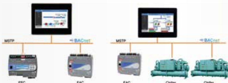
Interface utilisateur des équipements de CVC
